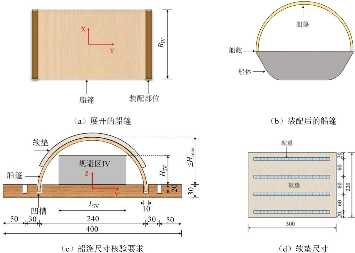
图 5 船篷结构尺寸、安装与核验要求（单位：mm）
